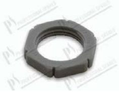
Hexagonal nut M20 - H=5,2 mm CH27
